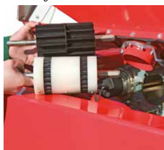
Egyszerű váltás a durva adagolókerékről finom adagolásra
