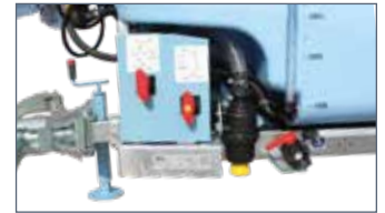
IT: Valvola di non ritorno sul risciacquo (su portati) / EN: Non-return valve on rinsing device (on mounted versions) / FR: Rinçage Ecoplus (sur portés) / DE: Rückschlagventil Spülsystem (bei aufgesattelten Modellen) / ES: Válvula de no retorno para el enjuague (en versiones suspendidas)
