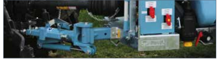
IT: Timone sterzante omologato stradale/bloccaggio idraulico (optional) / EN: Tracker drawbar for road approval/hydraulic lock (optional) / FR: Attelage articulé routier/option blocage hydraulique / DE: Lenkdeichsel für verkehrszugelassene Maschinen (hydraulische Blockierung-Option) / ES: Tiro articulado para homologación de carretera/bloqueo hidráulico (opcional)
