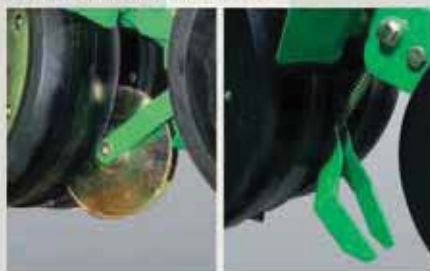
Gumi, vagy INOX magnyomó pro- kerék, csapágyazott lengőkarra szerelve. A keréket könnyen leszerelhetők.
