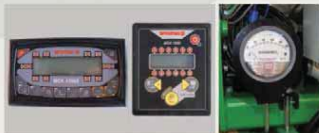
Elektronos vetésellenőrző monitorok, hektárszámláló funkciókkal, magszámlálással, sebességjelzéssel, stb.
