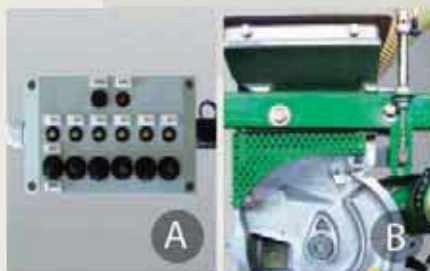
Kezelőpaneles sorlezárás visszajelző fényekkel (A) és munkahengeres (B) megoldással. A rendszer nagyon egyszerű, ebből adódóan nagyon megbízható, akár poros és sáros körülmények között is.
